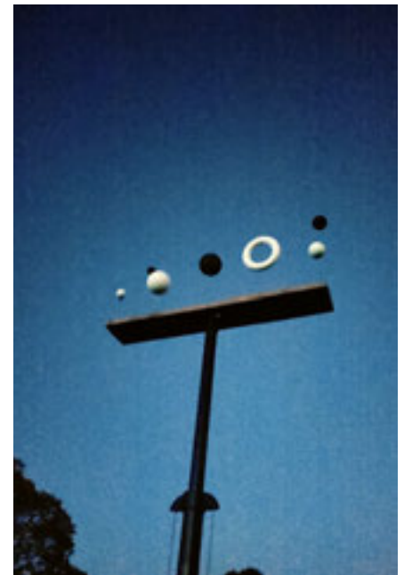
Testanlage, mit der geprüft wurde, ob sich Objekte abhängig von Grösse, Form und Farbe mit Infrarotstrahlung erkennen lassen.
