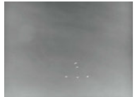
Eine Wärmebildkamera detektiert eine Fledermaus (linkes Bild: weisser Punkt in der linken Bildmitte) bzw. fünf Vögel (rechtes Bild), nämlich Graureiher, wie Fachpersonen aufgrund der Form feststellen können.
