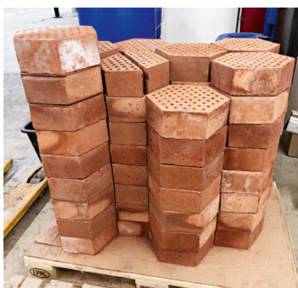
Formsteine aus Hochofenschlacke, die als Füllmaterial experimentell getestet wurden (hier ausserhalb des Tanks). Im Tank eingesetzt, werden die Löcher von Flüssigsalz durchströmt. Das erhöht die Wärmeübertragung auf das Füllmaterial.
